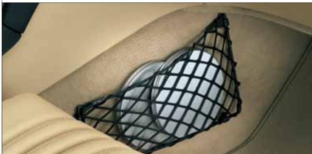
RETE DI TRATTENIMENTO OGGETTI SU TUNNEL CENTRALE
